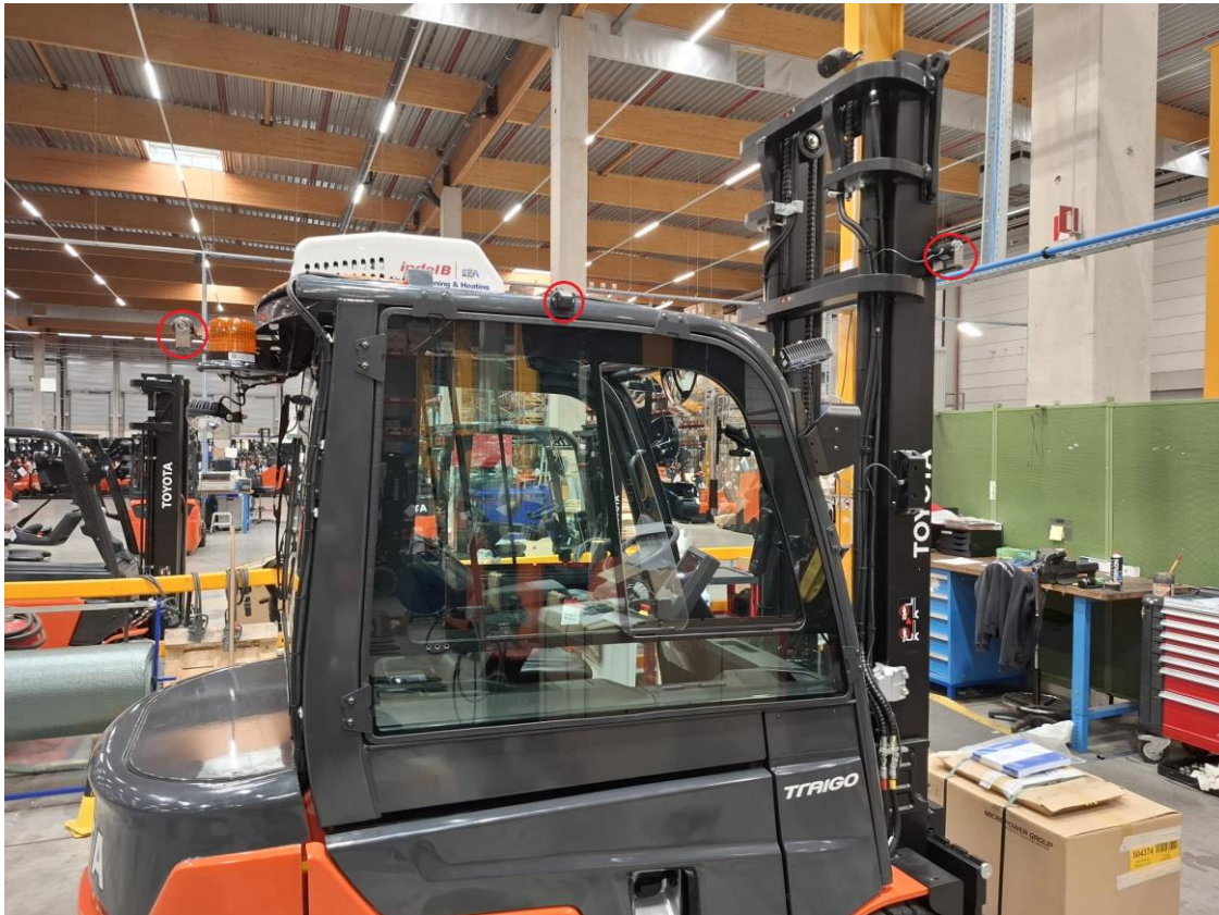
Cameraposities op de heftruck, gemonteerd en gekalibreerd door TOP-VISION.
