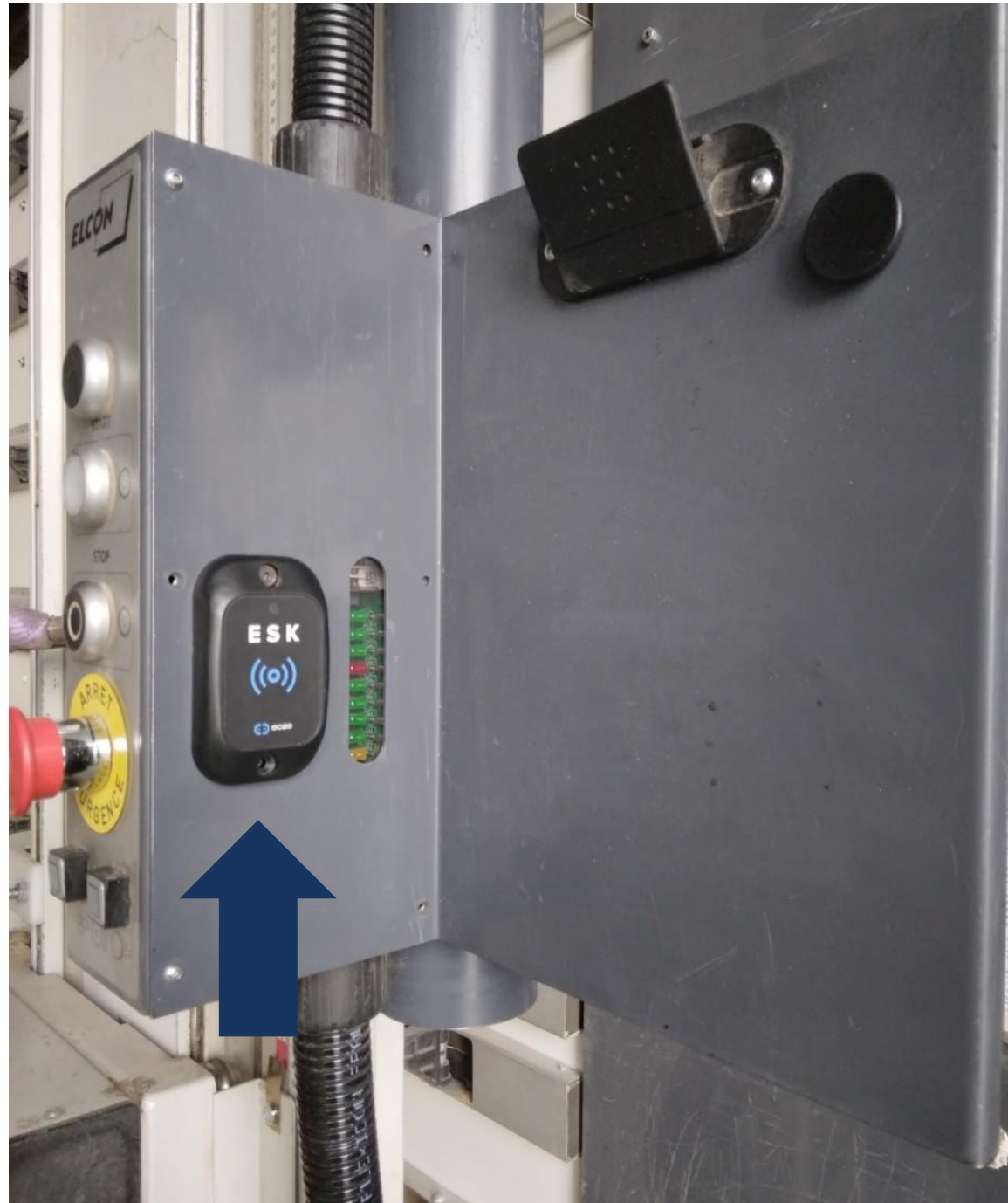
Badgelezer geïnstalleerd op de voorkant van de zaag voor gebruikersidentificatie.
