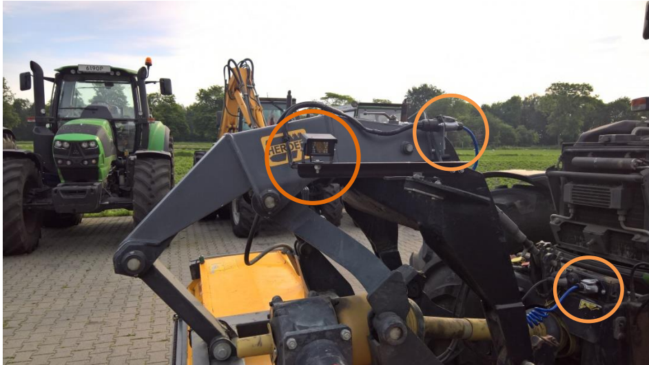
Vooranzicht links. Door een trailerkabelset zijn de cameras snel ontkoppelbaar
