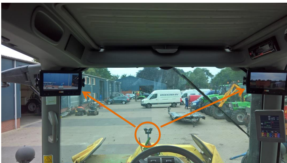
Binnen in de cabine bevinden zich 2 monitors om een duidelijk beeld te geven van de linker- en rechterszijde van het voertuig. In deze opstelling bevinden de 2 cameras zich rug aan rug.
